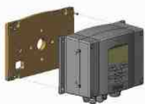
Wandinstallation mit Montageplatte*
