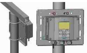
Installation mit Montagesatz für Rohrmasten
